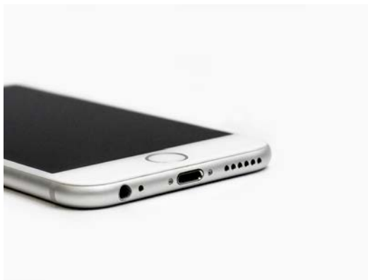
Ancien modèle d' iPhone avec prise jack en bas à gauche et bouton d'accueil.
